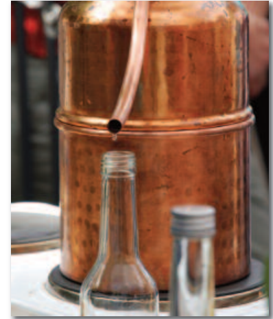
Zuhause kann man Hydrolate mit einer einfachen Kupfer-Destille gewinnen
